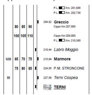
Analisi curva 317 a Greccio: ha una estesa di 277m imponendo una restrizione di velocità a 80(rango A)/85(rango B)/90(rango C)
