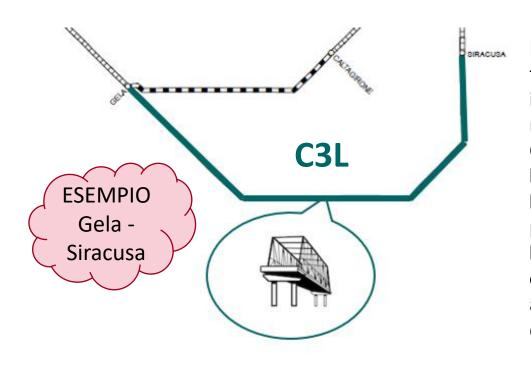
Linea classificata B2 fino a febbraio 2023 ma a seguito di interventi di rinnovo risanamento riclassificata in C3L (20 tonnellate/asse) con limitazione a 70 km/h su tutta tratta. Con ERTMS possibile imporre tale limitazione solo sui punti dove effettivamente necessaria, ad esempio in corrispondenza di specifiche opere d'arte.
